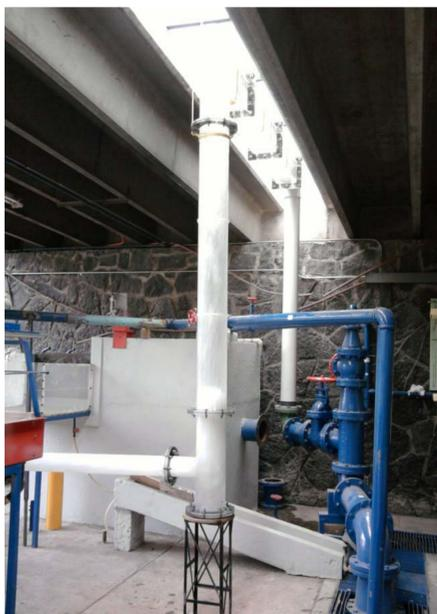
Figura 2. Modelo Hidráulico, escala 1:20
