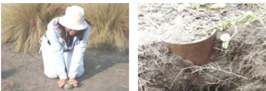
Colecta de muestras de suelo alteradas e inalteradas y para densidad aparente
