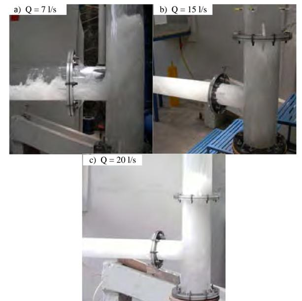
Figura 7. Conexión de la lumbrera con el túnel para los gastos ensayados.
