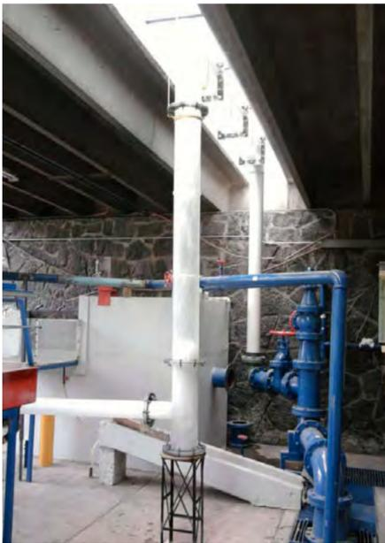
Figura 2. Modelo Hidráulico, escala 1:20
