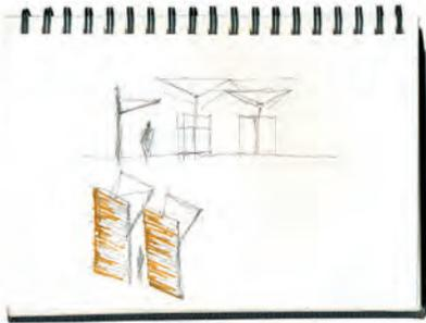
Al agrupar los paraguas, alternando la altura de los mismos se obtiene ventilación e iluminación natural indirecta, y se definen las circulaciones del mercado.
