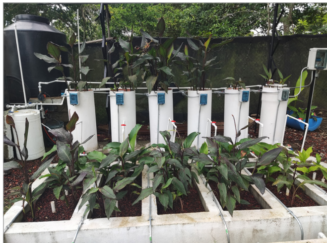
Figura 4. Sistema de humedales híbridos a escala piloto para tratamiento de lixiviados en el interior del Instituto Tecnológico Superior de Misantla.
