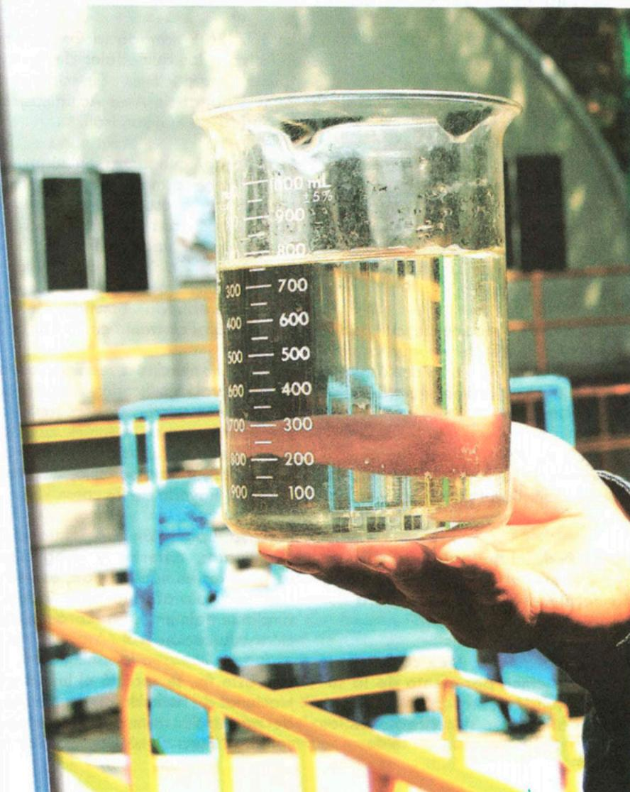
Para lograrlo se usa la tecnología de membranas de ultrafiltración, que tienen un tamaño de poro de 38 nanómetros (cada uno equivalente a la mil millonésima parte de un metro) que sólo permite el paso del agua. En el proceso, el líquido fluye por el sistema de placas planas rotatorias para retener los microorganismos. El efluente es colectado en un tanque y la biomasa que es obtenida es regresada al reactor biológico, señaló.
