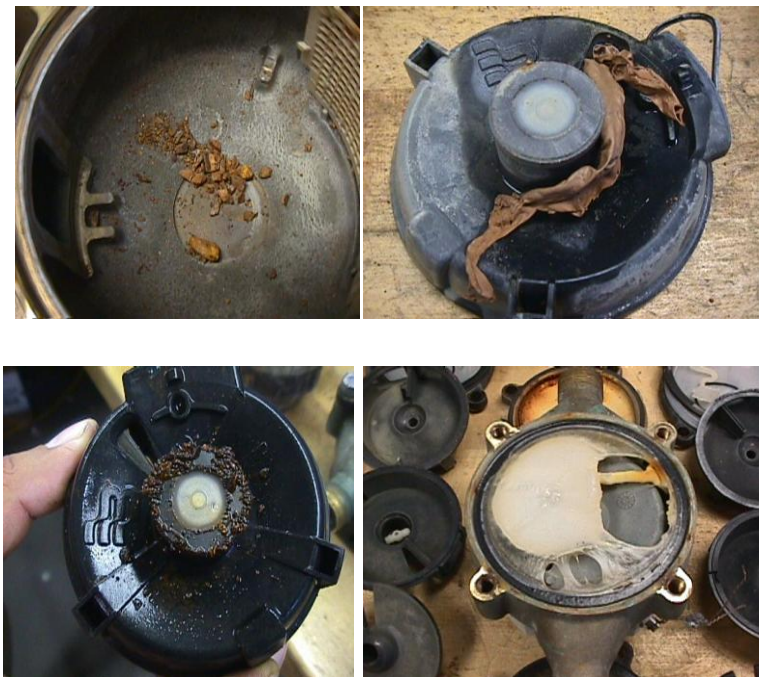
Figura 33. Incrustaciones en la cámara del medidor.
