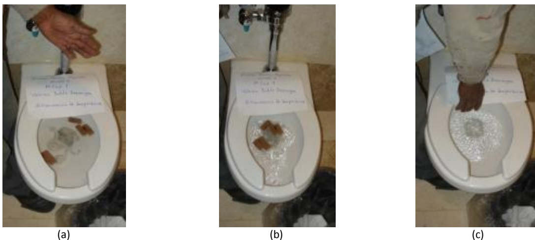
Figura 5. Prueba de eliminación de desperdicios. (a) Preparación, (b) Realización, (c) Resultado
