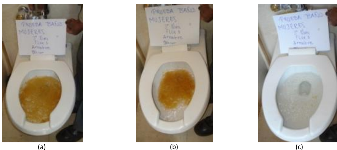
Figura 7. Prueba de arrastre. (a) Preparación, (b) Realización, (c) Resultado
