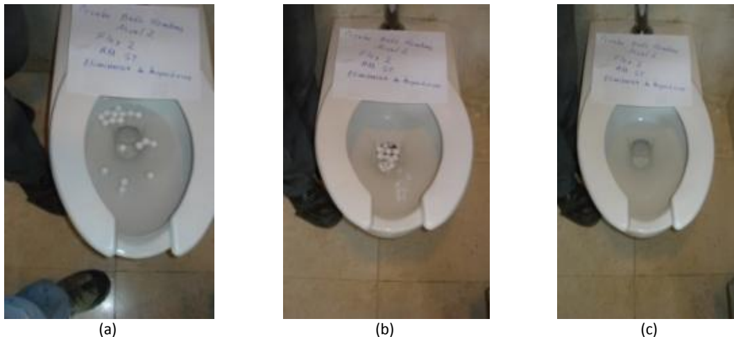
Figura 4. Prueba de exclusión de residuos. (a) Preparación, (b) Realización, (c) Resultado
