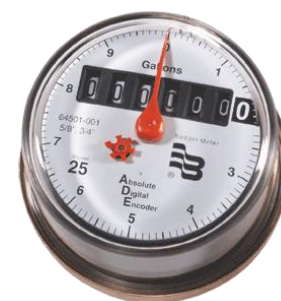
Figura 2. Carátula de medidor de agua
