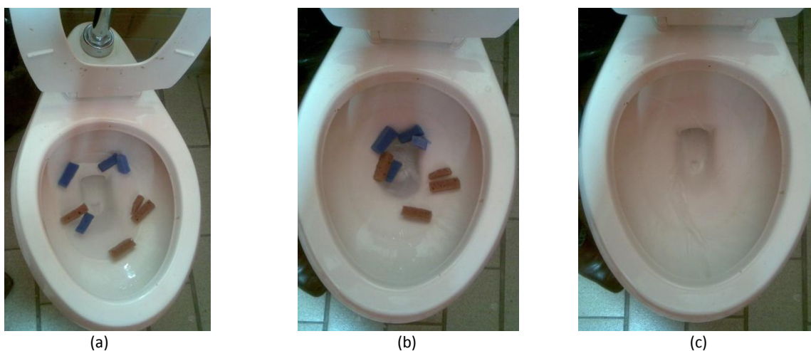
Figura 6. Prueba de barrido. (a) Preparación, (b) Realización, (c) Resultado
