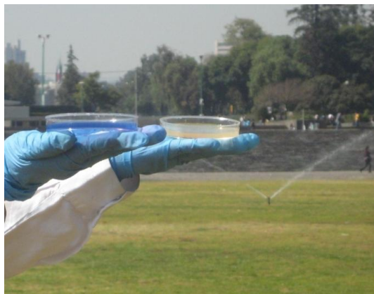
Figura 64. Monitoreo del aire en la zona de riego altura 1.40m
