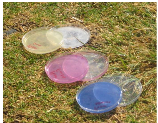
Figura 65. Monitoreo del aire en la zona de riego en el suelo
