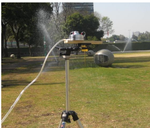
Figura 66. Equipo Andersen altura 1.15m
