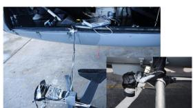
Cámara montada en el pedal de los helicópteros de la SEMAR.
