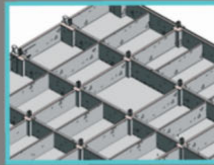
Acercamiento a aberturas inferiores de contratabas en cisternas para permitir el paso del agua a todas las divisiones
