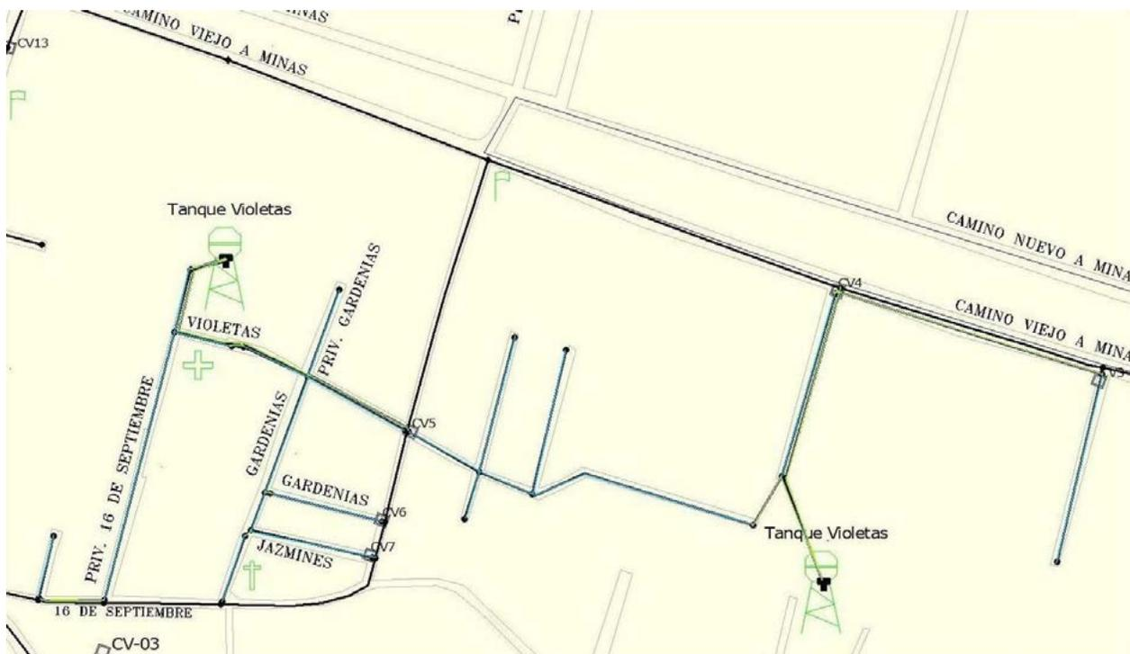
**Figura 28. Sustitución y colocación de líneas, para conectar los tanques Ocotlán de Morelos**
