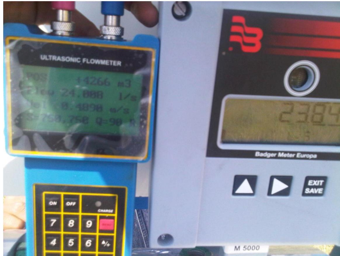
**Auditoría de medidor.** Con un equipo auditor portátil se compara el desempeño de un medidor permanente
