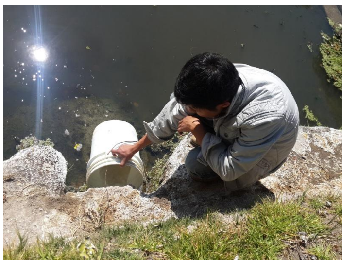
Figura 14 Aforo a la salida de la PTAR.
