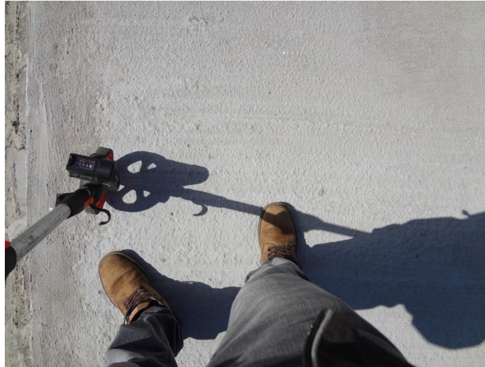
Ilustración 5 Medición con odómetro.
